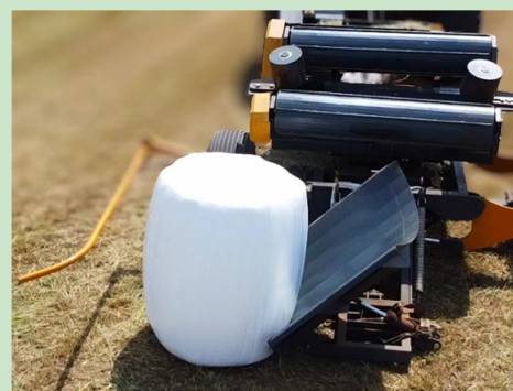
Mesa tombadora de fardos hidráulica automática
